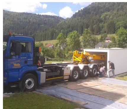
Garagenversetzung mit Versetz-Fahrzeug
